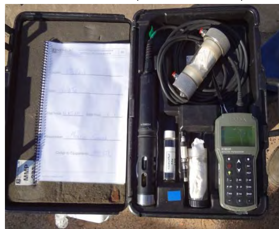
Foto 16 – Sonda Multiparâmetros Utilizada para Medições “in situ”, durante as campanhas (Data: 19/02/2020).
