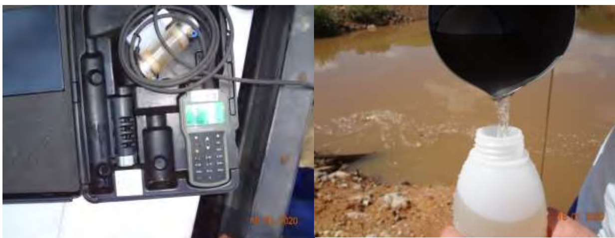
Fotos 3.2.1-1 e 3.2.1-2. Sonda multiparâmetros utilizada para medições “in situ” e armazenamento de amostra de água, respectivamente.
