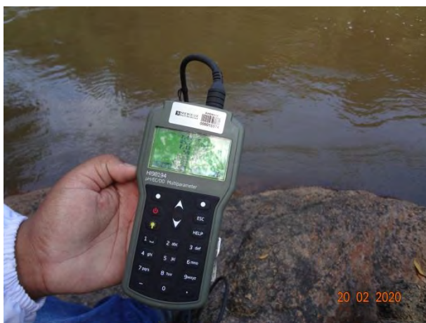
Fotos 3.2.1-1. Sonda multiparâmetros utilizada para medições “in situ”.
